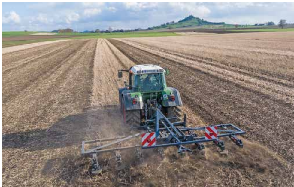
Das Team der Uni Köln testet den GrindStar seit 2021 in der Stoppelbearbeitung nach Wintergetreide und Winterraps. Foto: TH Köln
